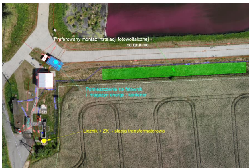
Rys nr. 7 Preferowana lokalizacja instalacji fotowoltaicznej. ZK - złącze kablowe
