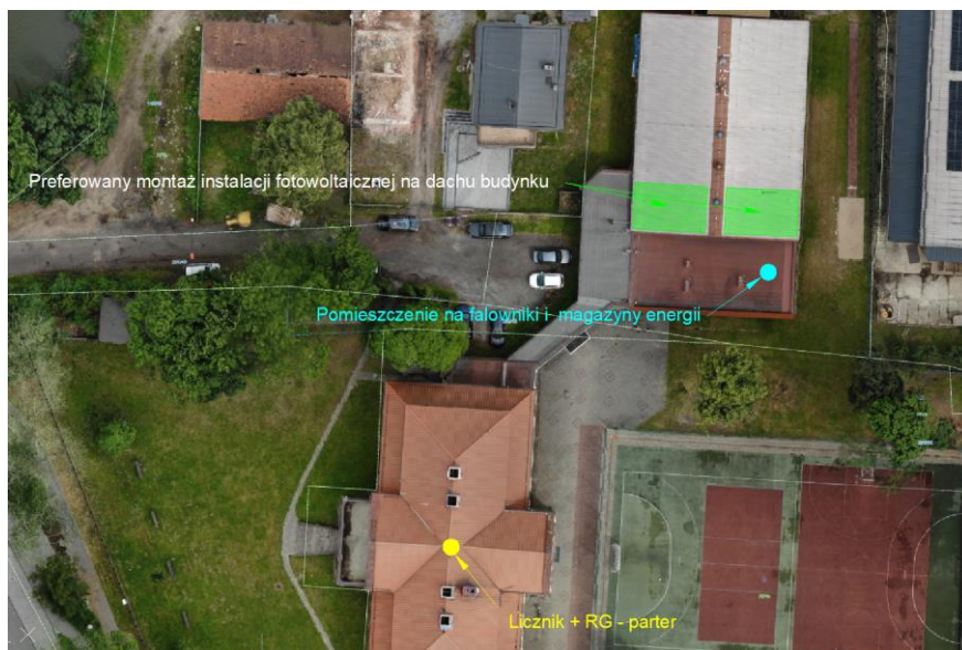
Rys nr. 2 Preferowana lokalizacja instalacji fotowoltaicznej. RG – rozdzielnica główna
