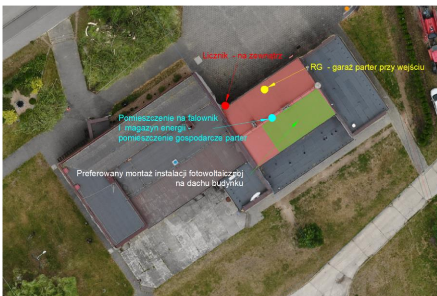
Rys nr. 10 Preferowana lokalizacja instalacji fotowoltaicznej. RG – rozdzielnica główna
