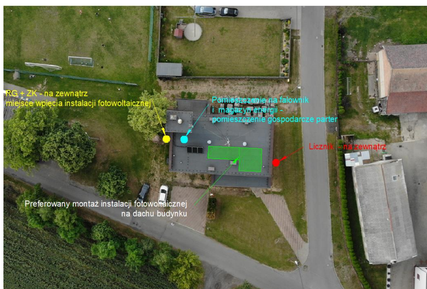
Rys nr. 20 Preferowana lokalizacja instalacji fotowoltaicznej. RG – rozdzielnica główna, ZK – złącze kablowe
