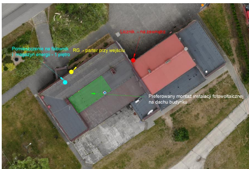
Rys nr. 11 Preferowana lokalizacja instalacji fotowoltaicznej. RG – rozdzielnica główna
