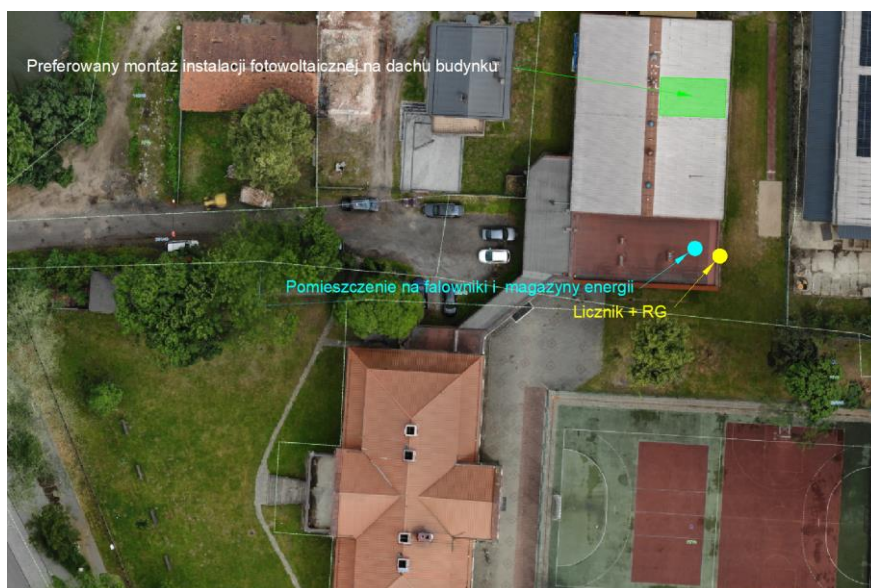
Rys nr. 1 Preferowana lokalizacja instalacji fotowoltaicznej. RG – rozdzielnica główna
