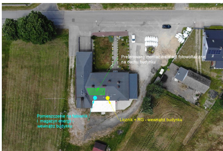
Rys nr. 21 Preferowana lokalizacja instalacji fotowoltaicznej. RG – rozdzielnica główna
