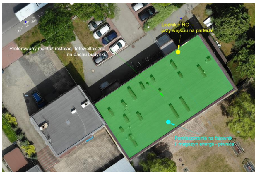
Rys nr. 15 Preferowana lokalizacja instalacji fotowoltaicznej. RG – rozdzielnica główna
