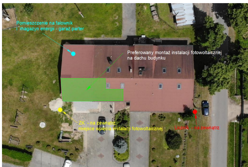
Rys nr. 8 Preferowana lokalizacja instalacji fotowoltaicznej. ZK - złącze kablowe
