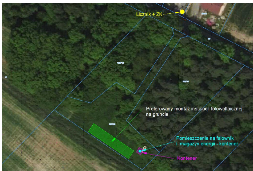
Rys nr. 4 Preferowana lokalizacja instalacji fotowoltaicznej. ZK – złącze kablowe
