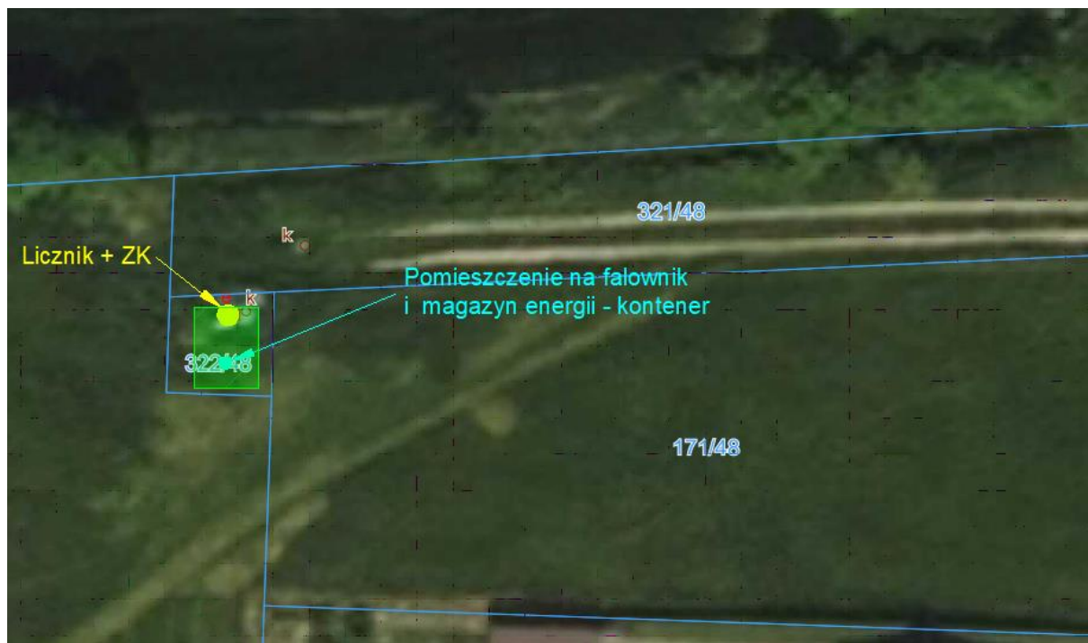
Rys nr. 5 Preferowana lokalizacja instalacji fotowoltaicznej. ZK – złącze kablowe
